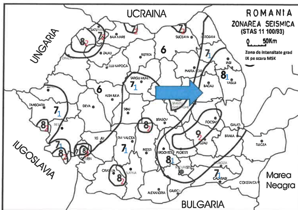
Fig. 7 – Zonarea Teritoriului din punct de vedere seismic
